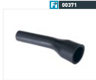
Ürün Adı : XF95 Yağ Doldurma Borusu Hortumu Product N. : Oil Filler Pipe Hose Oem No. : 1317358 Ölçü/Size : Q 25x45x238 mm
