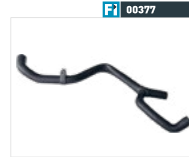
Ürün Adı : XF105 Kalorifer Su Hortumu Product N. : Heating Water Hose Oem No. : 1645506 - 1600191 Ölçü/Size : Q 27x31x890 mm
